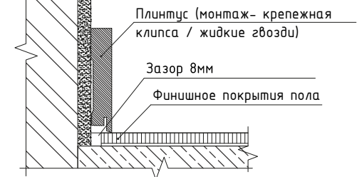
Штукатурный слой с финишным покрытием стены Узел примыкания плинтуса к стене М1:4
